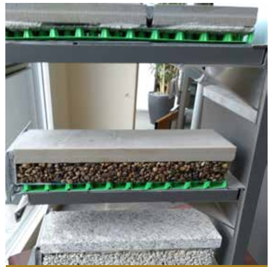
Gebundene Bauweise (Betonplatten)
